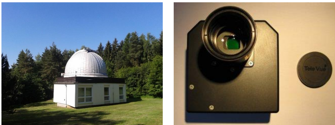
Рисунок 2.1– Правая панель: Камера G2-3200 с корректором комы Paracorr PLA-200. Левая панель: павильон 0,65-метрового телескопа в Ондржеёве, Чешская Республика.
